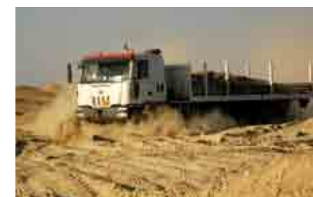
HHD 6x6 passo extra lungo 6100mm, cabina lunga, cambio 16S221 con WSK440 e sistema di gonfiaggio/sgonfiaggio pneumatici dal posto di guida HHD 6x6 extra-long length 6100mm, long cabin, gearbox 16S221 with WSK440 tyre inflation/deflation system controlled from driver position
