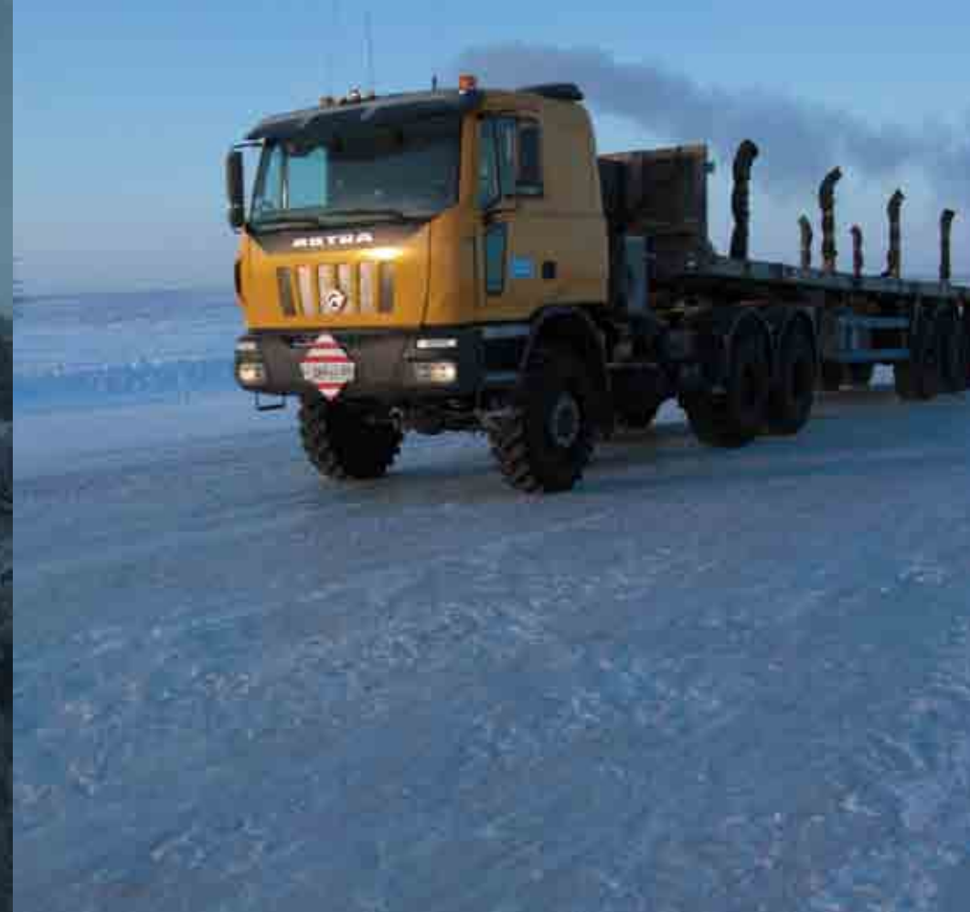
6x6 Trattore con gommatura da ghiaccio con winterizzazione completa 6x6 Tractor with ice tyres with complete winterization
